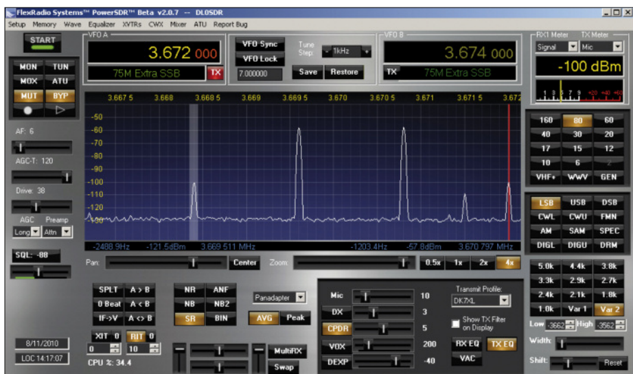
Bild 5: IMA-Messung mit PowerSDR an einem FLEX-1500 auf dem 80-m-Band, der nur mit etwa 1 W PEP angesteuert wird; als „Messgerät“ diente ein FLEX-3000.
